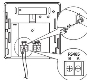
Retire la funda usando la guía como se muestra en la siguiente figura durante el proceso de cableado T/B, y luego inserte un protector corto en la junta tórica o en el terminal U para el cableado.
