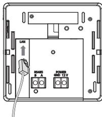
5. Conecte la alimentación de 12V  $\overline{\text{---}}$  suministrada en la unidad externa al terminal de alimentación ubicado en la parte posterior de la unidad principal del controlador.
