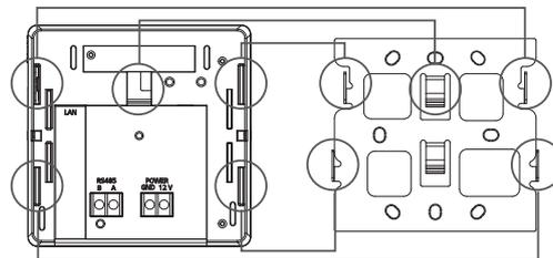
7. Abaisser le produit pour verrouiller le crochet. Fixer la plaque d'installation et le produit à l'aide des vis de fixation du contrôleur après le verrouillage.
