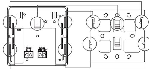
7. Baje el dispositivo para bloquear el gancho. Fije la placa de instalación y el dispositivo utilizando los tornillos de fijación del controlador después de bloquearlo.
