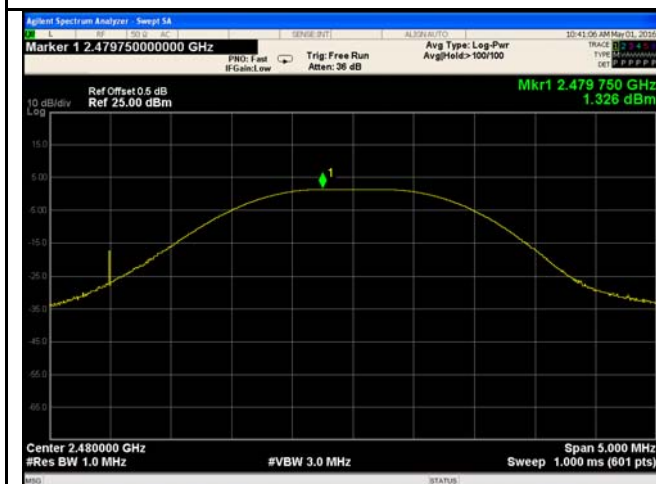
AV Output power - High CH 2480
